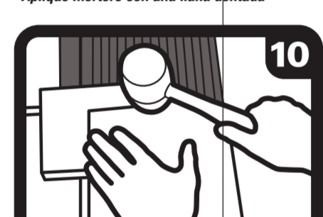
Level tile surface with other tile Nivele la superficie de azulejos o baldosas con otros azulejos o baldosas
