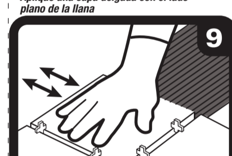
Press tile firmly into place Presione las baldosas o los azulejos firmemente en su sitio
