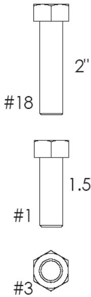
ATTACHEZ LES BRAS DE TREUIL À LA PLAQUE DE MONTAGE EN UTILISANT LES BOULONS 2" ET LES CONTRE-ÉCROUS
