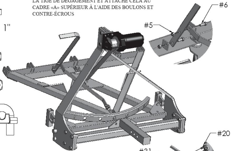
UTILISEZ LE BOULON «U» ET LES CONTRE-ÉCROUS POUR ATTACHER L'AUTRE EXTRÉMITÉ DE LA TIGE DE DÉGAGEMENT À LA CLAVETTE DE DÉCLENCHEMENT ACTIONNÉ PAR RESSORT SITUÉE SUR LE CADRE EN «A» SUPÉRIEUR
