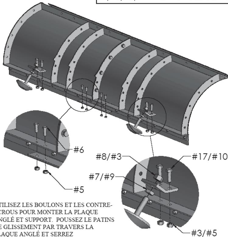
UTILISEZ LES BOULONS ET LES CONTRE-ÉCROUS POUR MONTER LA PLAQUE ANGLÉ ET SUPPORT. PUSSEZ LE PATINS DE GLISSEMENT PAR TRAVERS LA PLAQUE ANGLÉ ET SERREZ
