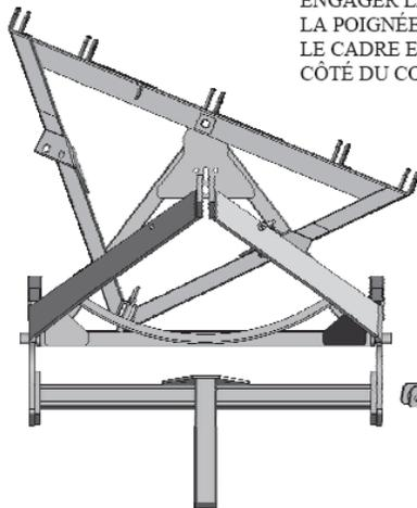
ENGAGER LA CHAÎNE DE SÉCURITÉ, UTILISER LA POIGNÉE DE DÉGAGEMENT POUR DÉPLACER LE CADRE EN «A» SUPÉRIEUR DE LA FENTE DU CÔTÉ DU CONDUCTEUR.
