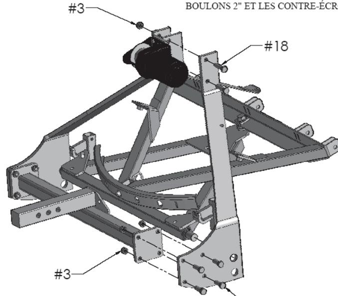
ATTACHEZ LES BRAS DE TREUIL SUR LE CADRE «A» INFÉRIEURE ET LA TRAVERSE EN UTILISANT LES BOULONS 1.5" ET LES CONTRE-ÉCROUS
