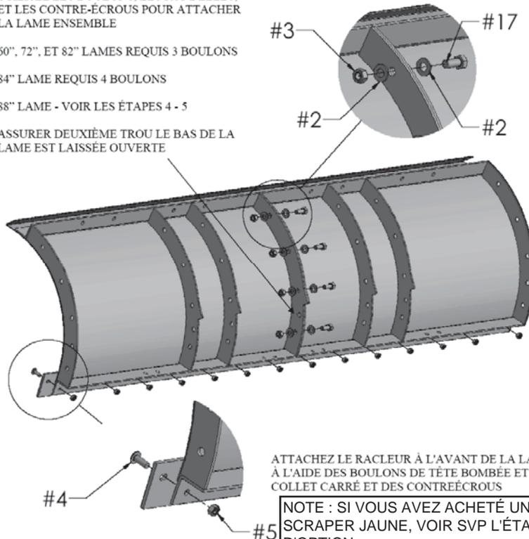
ATTACHEZ LE RACLEUR À L'AVANT DE LA LAME À L'AIDE DES BOULONS DE TÊTE BOMBÉE ET COLLET CARRÉ ET DES CONTRE-ÉCROUS
