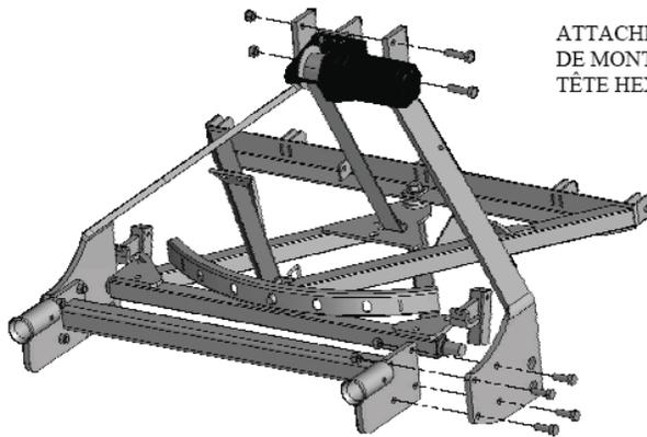
ATTACHEZ LES BRAS DE TREUIL A LA PLAQUE DE MONTAGE EN UTILISANT 2" BOULONS À TÊTE HEX ET LES ÉCROUS
