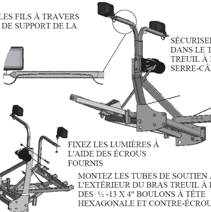
SÉCURISER LES CÂBLES DANS LE TUBE ET BRAS TREUIL À L'AIDE DES SERRE-CÂBLES
