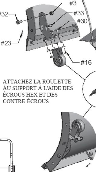
ATTACHEZ LA ROULETTE AU SUPPORT À L'AIDE DES ÉCROUS HEX ET DES CONTRE-ÉCROUS
