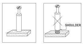
NOTE: TURN THE CAM-BOLT SCREWS UNTIL THEY ARE TIGHT, THE SHOULDER SHOULD BE AGAINST THE SURFACE OF THE PART.
