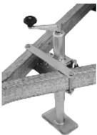
**Vérin:** Dispositif optionnel de la remorque qui sert à lever et abaisser la flèche (l'avant) de la remorque. Il ne sert qu'à faciliter l'attelage de la remorque et ne doit pas être utilisée pour stocker des matériaux dans la remorque sans support additionnel. Le verin doit être immobilisé ou retiré avant le remorquage.
