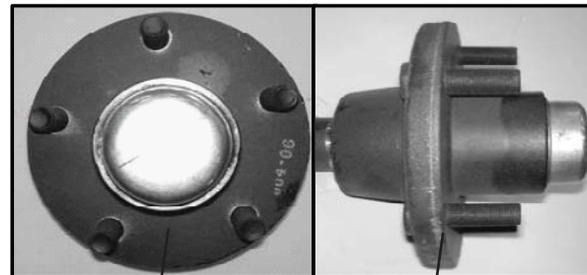
**Remarque :** Le chemin de roulement (no 4) est entré sous pression dans le moyeu et ne doit pas nécessairement être remplacé lors du remplacement des paliers.
