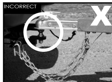
**Le loquet de la tête d'attelage doit toujours être fermé lorsque la remorque est tractée !**
