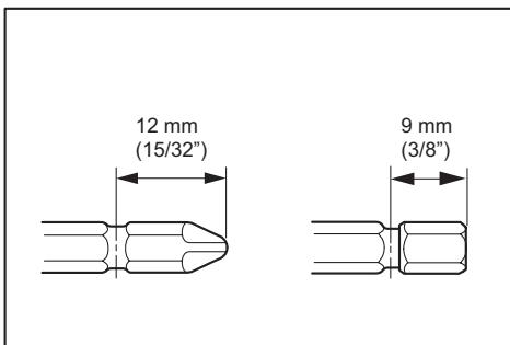
Utilice únicamente la punta de destornillador/punta de atornillar que se muestra en la figura. No utilice ninguna otra punta de destornillador/punta de atornillar.
