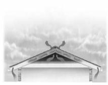
Para calcular el valor mínimo de la ventilación requerida, use las relaciones 1/300 ó 1/150. En las páginas interiores, hemos realizado los cálculos necesarios para su comodidad. Use la relación 1/300 si tiene una distribución correcta de aberturas de ventilación en el sofito y capotes ventilados en la cumbrera o si cuenta con un retardador de vapor. Use la relación 1/150 si no puede obtener una distribución correcta de ventilación y no dispone de un retardador de vapor.
