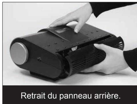
**Nettoyage minutieux de la poussière:** Les broches de l'ionisateur peuvent aussi être nettoyées à fond. Pour le faire, enlever le panneau arrière en appuyant doucement là où indiqué par les deux flèches et en tirant vers l'extérieur. La barre en acier inoxydable avec les broches de l'ionisateur à l'avant peut être nettoyée, de préférence à l'aide d'une brosse trempée dans de l'alcool dénaturé.
