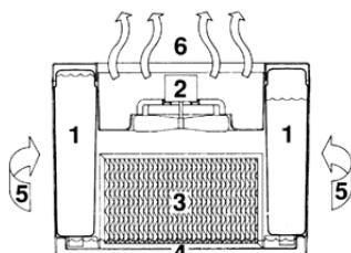
Une fois que le filtre est saturé d'eau, de l'air est attiré dans l'appareil, il passe à travers le filtre et l'humidité est absorbée dans l'air.
