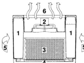
Todos evaporación se produce en el humidificador por lo que cualquier residuo permanece en la mecha. este proceso natural de evaporación no crea polvo blanco como algunos otros humidificadores.
