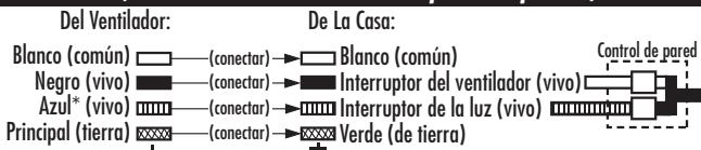
\*Conecte el cable azul sólo si conecta un juego de luces al ventilador.
