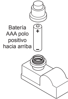
Figura 12 - Instalación de la batería en Ignitor
