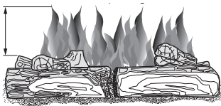
Figura 27 - Patrón incorrecto de la llama del quemador
