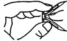
Fig. 17 - Cómo doblar el soporte de expansión
