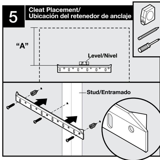
Use measurement "A" to position cleat on wall. Elongated holes enable adjusting. Use all included screws (and anchors as needed). **NOTE:** Bent corners face wall to act as safety catch./Use la medida "A" para ubicar el retenedor de anclaje en la pared. Los orificios alargados permiten el ajuste. Use todos los tornillos incluidos (y los anclajes que necesite). **NOTA:** Las esquinas dobladas dan hacia la pared como retén de seguridad.
