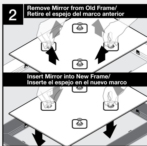
Lift from posts./Levante usando los soportes.
