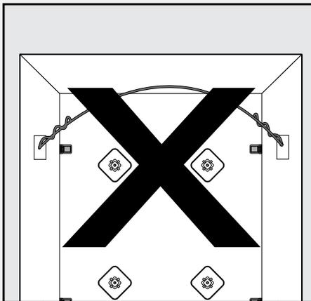
DO NOT attach hooks/wire to frame. Frame will not support weight of mirror./NO sujete ganchos/cables al marco. El marco no soportará el peso del espejo.
