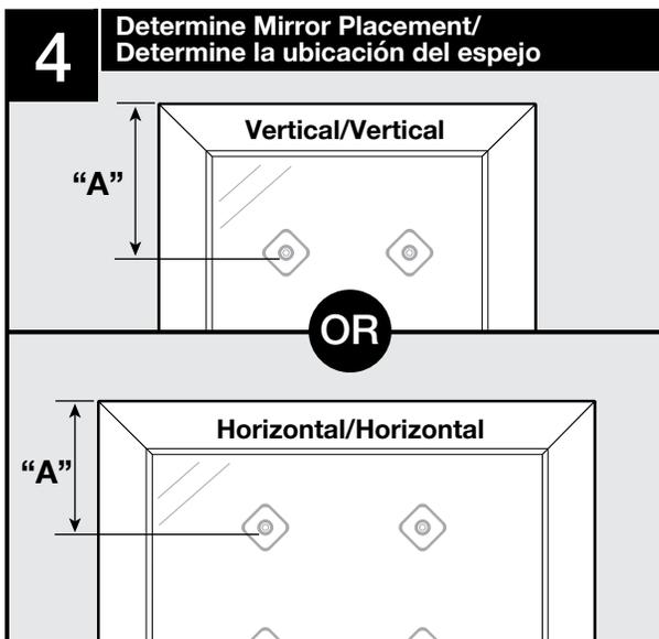
Measure from top of frame (or mirror if frameless) to post to identify measurement "A"/Mida desde la parte superior del marco (o del espejo si no usa el marco) hasta el soporte para identificar la medida de "A".
