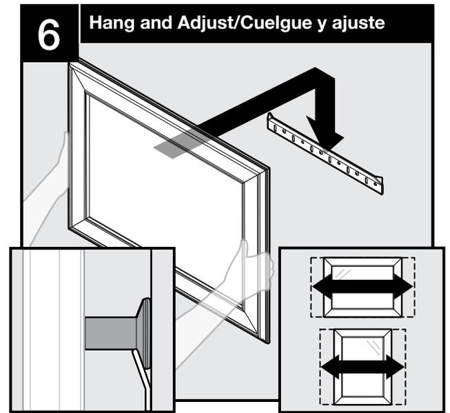
Posts rest on cleat./ Los soportes descansan sobre el listón de anclaje.
