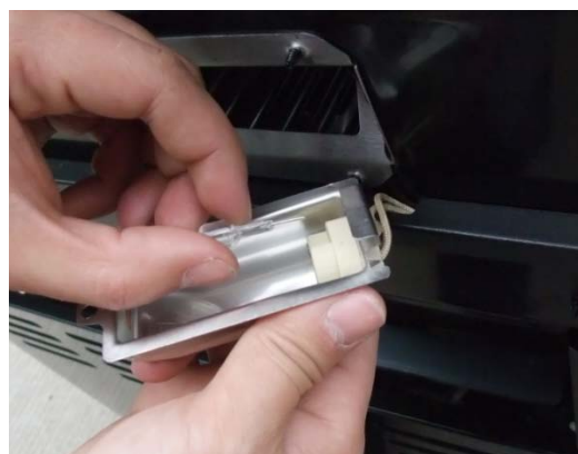
5. Presione el botón en el extremo de la caja del bulbo para liberar y quitar el vidrio de la caja de la bombilla.
