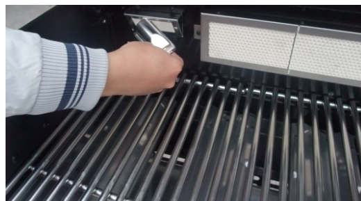
4. Retire la carcasa del bulbo de la luminaria.
