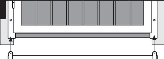
Colocar la barra inferior (**D**) debajo de las jambas laterales. Ambos extremos deben llegar hasta el borde exterior de las jambas laterales. Mantener en el lugar y perforar los orificios para los tornillos de montaje con una broca de  $5/32"$ . Fijar la barra inferior a cada jamba lateral con los tornillos (**H**) provistos.
