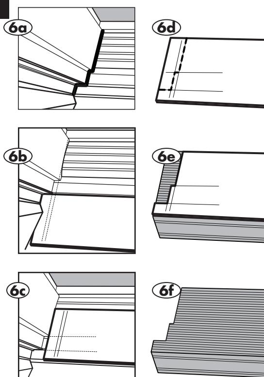
El contorno del marco de la puerta varía (**6a**) por lo tanto es necesario cortar la placa de umbral (**E**) para que encaje. Recomendamos cortar una plantilla de cartón para ajustar primero a la abertura con el fin de evitar dañar de manera irreversible la placa de umbral.
