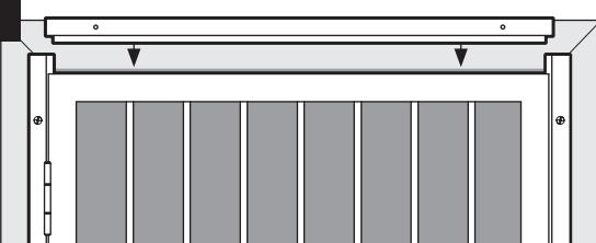
Colocar la jamba del travesaño superior (**C**) sobre la puerta y entre las dos jambas laterales. El espacio debe ser igual, de izquierda a derecha, sobre la puerta y ser similar al espacio determinado en el **Paso 3**. Marcar la ubicación de los orificios de montaje. Poner las jambas a un lado y donde esté marcado perforar los orificios de  $3/16"$ . Volver a colocar la jamba en su lugar y fijar a la estructura utilizando los tornillos unidireccionales (**G**) provistos.
