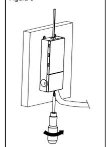
10. Vuelva a conectar la electricidad en la caja de fusibles o disyuntores. Si las lámparas no se encienden dentro de los siguientes 5 segundos, interrumpa la alimentación e inspeccione todas las conexiones de conductores.
