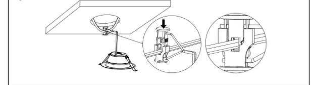
6. Pliegue los ganchos de resorte sobre el cuerpo de la lámpara (vea la figura 6) e insértela en la abertura en el techo. Cuando ambos ganchos hayan alcanzado el borde de la abertura, libéretos lentamente y lleve hacia arriba la lámpara hasta que los ganchos se abran sobre la superficie interior del techo. (Vea la figura 6)
