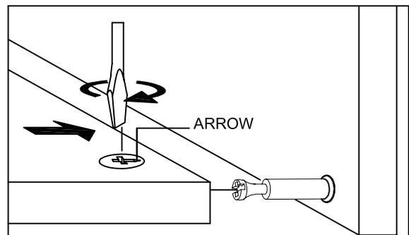
NOTE: • THE ARROWS ON THE HIDDEN CAM-LOCKS SHOULD POINT TO THE CAM-BOLTS.
