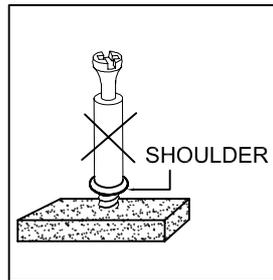
NOTE: TURN THE CAM-BOLT SCREWS UNTIL THEY ARE TIGHT, THE SHOULDER SHOULD BE AGAINST THE SURFACE OF THE PART.
