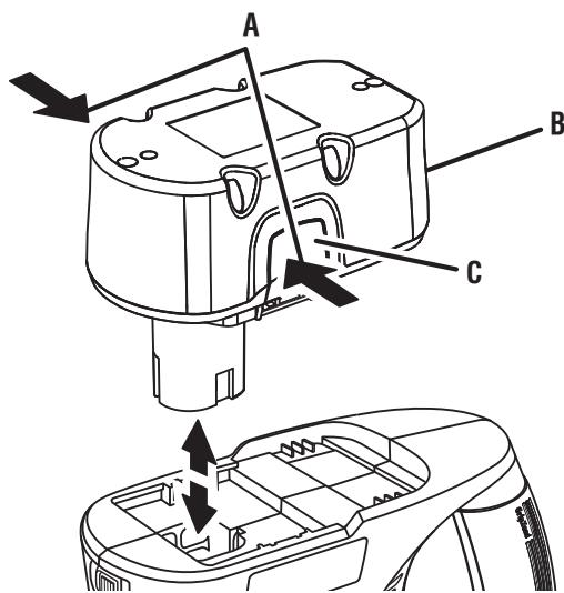
A - Depress latches to release battery pack (appuyer sur les loquets pour libérer le bloc de batteries, para soltar el paquete de baterías oprima los pestillos)
