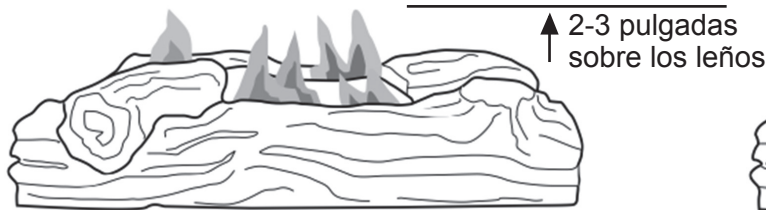
Fig. 22 - Patrón correcto de la llama del quemador
