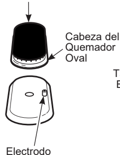
Tapa del Quemador Oval (No Extraíble)
