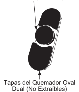
Quemador Oval Dual (en algunos modelos)
