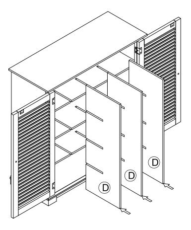
• SLIDE THE DIVIDER (D) VERTICALLY TO THE PROPER POSITION AGAINST THE FIXED SHELF (C).
