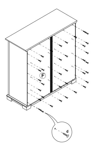
• TIGHTEN THE BACK PANEL (F) TO THE ASSEMBLED PART BY USING THE ROUND HEAD SCREW (d).
