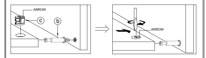
NOTE: • THE ARROWS ON THE HIDDEN CAM-LOCKS SHOULD POINT TO THE CAM-BOLTS.
