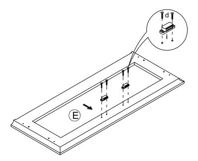
• TIGHTEN THE MAGNET (i) TO THE TOP PANEL (E) BY USING THE ROUND HEAD SCREW (d).
