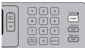
Appuyer sur la touche START (mise en marche) pendant 5 secondes, jusqu'à ce que "CONTROL LOCK" (commande verrou) apparaisse sur l'afficheur.
