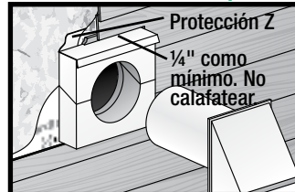
Ilustración 13 Penetración de bloque
