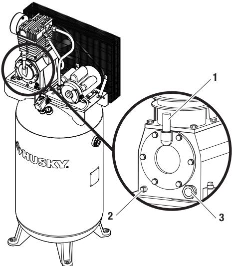
**REMARQUE :** Utilisez une huile pour compresseur 30W ou une huile de service sévère SAE 30W, non détergente, SF ou de qualité supérieure. N'utilisez pas des huiles pour moteur d'automobiles multigrades, car elles réduiraient la durée de vie du compresseur. Utilisez de l'huile SAE-10 dans les conditions hivernales extrêmes.
