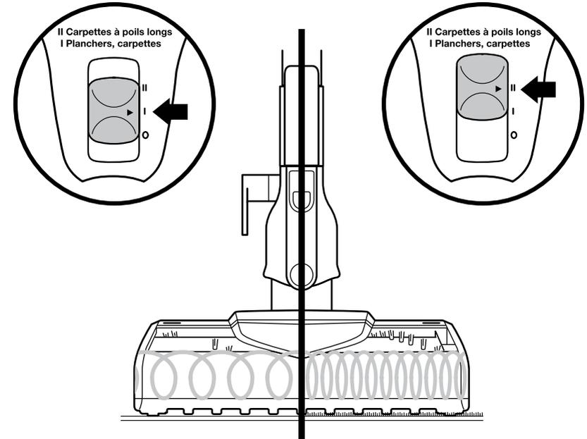
La poignée de l'aspirateur Rocket<sup>MC</sup> est munie d'un interrupteur coulissant à deux vitesses qui permet de sélectionner la vitesse de la brosse rotative. Réglez l'interrupteur à la vitesse souhaitée (I ou II) et commencez le nettoyage.
