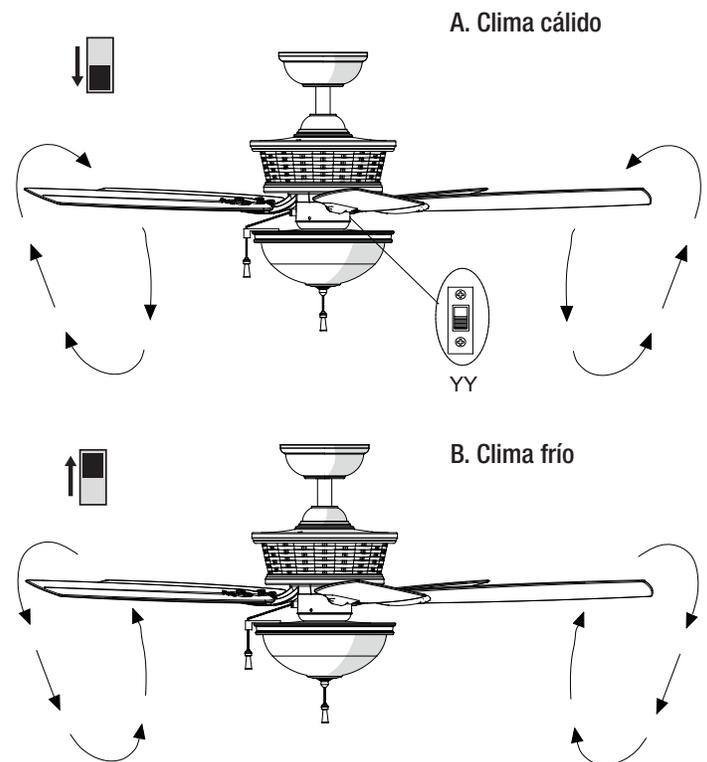
A. Clima cálido - (Hacia adelante) Un flujo de aire descendente surte un efecto refrescante. Esto te permite programar el aire acondicionado en configuración más alta sin afectar tu comodidad.
