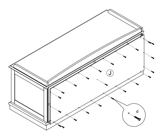
• TIGHTEN THE BACK PANEL (J) TO THE ASSEMBLED PART BY USING THE 1/2"L ROUND HEAD SCREW (d).
