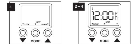
3. Para fijar las horas, pulse el botón descendente ▼ a fin de bajar la hora o el ascendente ▲ para subirlo. Nota: el reloj tiene 24 horas y mostrará los indicadores AM o PM para distinguir entre la mañana y la tarde. El icono AM/PM cambiará a medida que se ajusten las horas.
