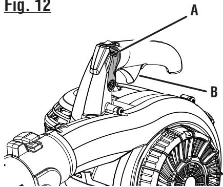
A - Cruise control lever (levier de régulateur de vitesse, palanca de control de crucero)
