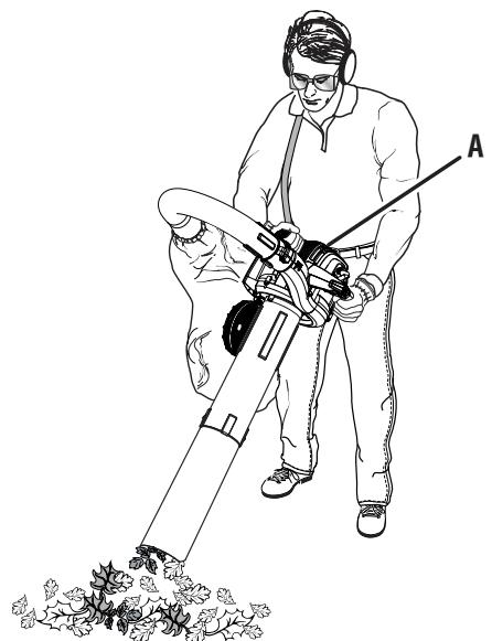
A - Keep muffler away from the body (garder les mains à l'écart des silencieux, mantenga el silenciador alejado del cuerpo)
