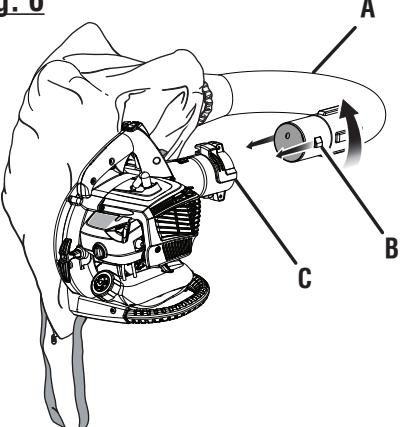
A - Adaptor installed in vacuum bag (adaptateur installé dans le sac à débris, adaptador instalado en el saco de la aspiradora)
