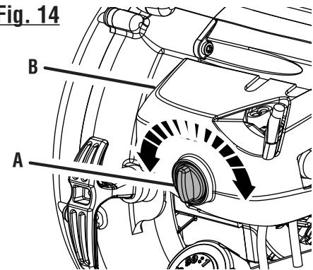
A - Turn the dial to open and close (tourner le cadran pour ouvrir et fermer, gire el selector para abrirla y cerrar )
