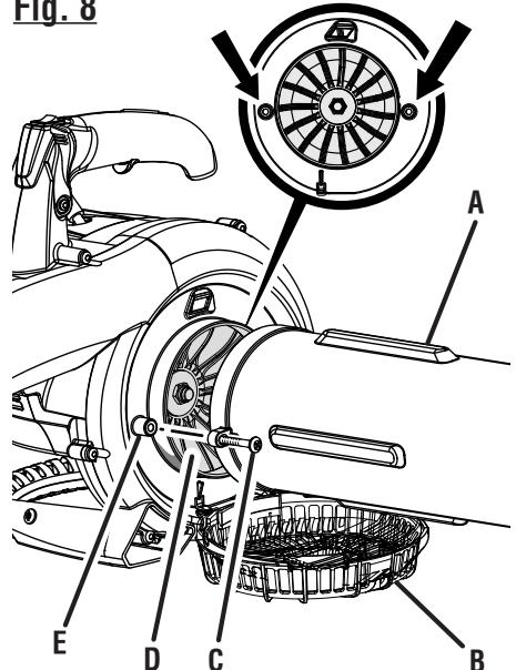
A - Vacuum tube assembly (ensemble de tubes d'aspiration, conjunto de los tubos de la aspiradora)
