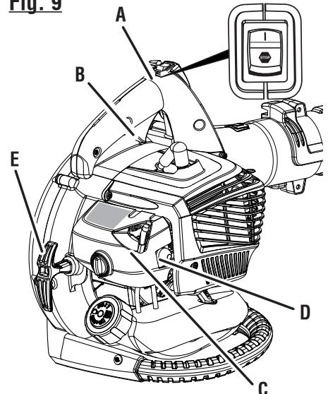
A - Stop switch (commutateur d'arrêt, interruptor del apagado)
