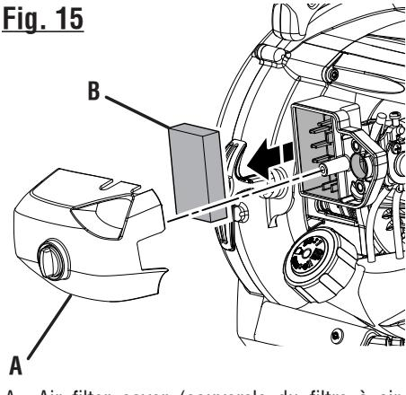
A - Air filter cover (couvercle du filtre à air, cámara del filtro de aire)
