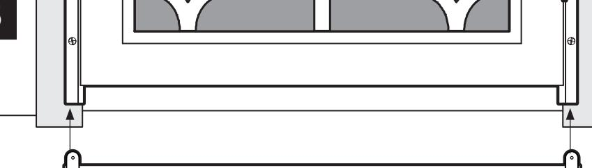
Colocar la barra inferior (D) debajo de las jambas laterales. Ambos extremos deben llegar hasta el borde exterior de las jambas laterales. Mantener en el lugar y perforar los orificios para los tornillos de montaje con una broca de 5/32". Fijar la barra inferior a cada jamba lateral con los tornillos (H) provistos.
