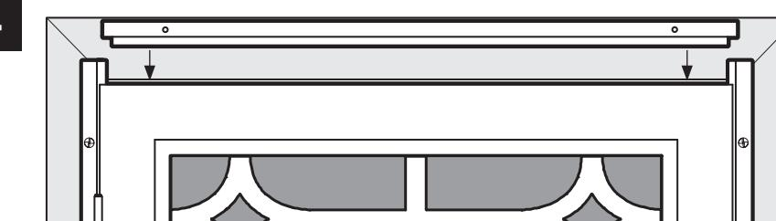
Colocar la jamba del travesaño superior (C) sobre la puerta y entre las dos jambas laterales. El espacio debe ser igual, de izquierda a derecha, sobre la puerta y ser similar al espacio determinado en el **Paso 3**. Marcar la ubicación de los orificios de montaje. Poner las jambas a un lado y donde esté marcado perforar los orificios de 3/16". Volver a colocar la jamba en su lugar y fijar a la estructura utilizando los tornillos unidireccionales (G) provistos.
