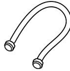
Línea de suministro de agua del inodoro
