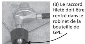
(B) Le raccord fileté doit être centré dans le robinet de la bouteille de GPL.
