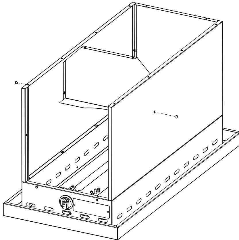
INSTALL BOTTOM ASSEMBLY AS SHOWN USING QTY 14 #10 SCREWS.
