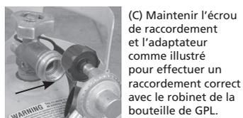
(C) Maintenir l'écrou de raccordement et l'adaptateur comme illustré pour effectuer un raccordement correct avec le robinet de la bouteille de GPL.
