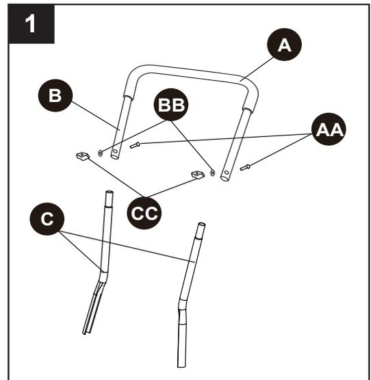
2. Fije el subensamble de la manija superior a la manija inferior (D) con cuatro pernos cabeza de hongo (AA), arandelas (BB) y perillas de fijación (CC).
