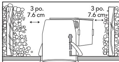
\* Possibilité d'utiliser les modèles GU10 MAX 50 W (Tout matériel isolant doit demeurer en tout temps à au moins 7,6cm (3") du boîtier.)
