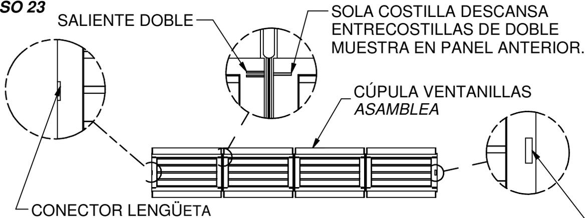
**DOBLE CÚPULA VENTANILLAS PANEL EN FORMA CUADRADA Y DE TRABA EN SU LAGAR DESLIZANDO LENGÜETA DEL CONECTOR AL RANURA DEL CONECTOR.**
