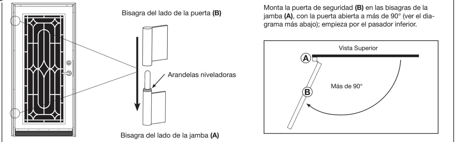
Monta la puerta de seguridad (B) en las bisagras de la jamba (A), con la puerta abierta a más de 90° (ver el diagrama más abajo); empieza por el pasador inferior.
