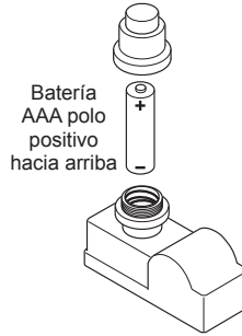
Figura 20 - Instalación de la batería en Ignitor
