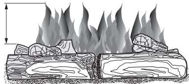
Figura 25 - Patrón incorrecto de la llama del quemador
