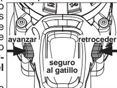
Para retroceder (el giro es en el sentido opuesto a las manecillas del reloj), se presiona el interruptor de control colocado al lado izquierdo del taladro. **Verificar la dirección del giro antes de usarlo.**
