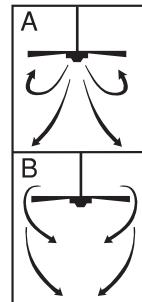
NOTA: Apague el ventilador y espere a que se detenga antes de cambiar la dirección de adelante/atrás con el conmutador de tipo deslizante.
