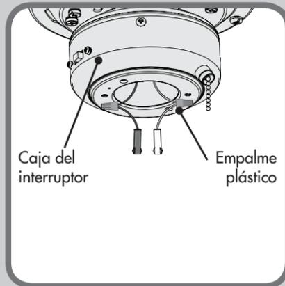
Si su ventilador no posee conectores de pines en los cables provenientes de la caja del interruptor, instale el manajo de cables proporcionado. Utilice los conectores de cables proporcionados para conectar el cable blanco del ventilador con el cable blanco del manajo de cables y conecte el cable negro o azul del ventilador con el cable negro del manajo de cables.
