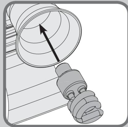
**Instalación de la bombilla** - Instale una bombilla en cada portalámparas. De ser necesario, reemplace las bombillas por bombillas del mismo tipo y voltaje.
