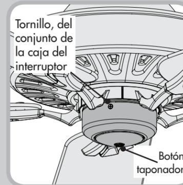
Si la tapa de la caja del interruptor de su ventilador se parece a ésta, quite toda la caja del interruptor; para ello deberá quitar los tornillos de la caja del interruptor con un destornillador estrella (Phillips). Quite el botón de tapón. A continuación siga las **INSTRUCCIONES DE MONTAJE TIPO B**.
