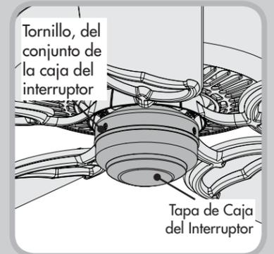
Si la tapa de la caja del interruptor de su ventilador se parece a ésta, quite toda la caja del interruptor; para ello deberá quitar los tornillos de la caja del interruptor con un destornillador estrella (Phillips). Quite los dos tornillos de la tapa desde el interior de la caja del interruptor. Reinstale la caja del interruptor. Apriete los tornillos de la caja del interruptor. A continuación siga las instrucciones de **MONTAJE TIPO A**.
