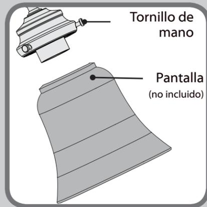
Para instalar la pantalla, primero afloje los tornillos de mano. Levante la pantalla a la lámpara. Apriete firmemente los tornillos de mano.
