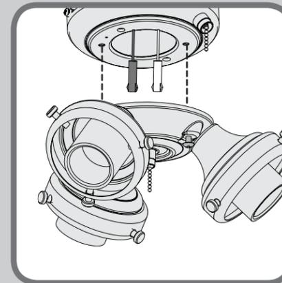
Levante el juego de luz para que coincida con la caja inferior del interruptor. Inserte los dos tornillos preinstalados del juego de luz en los orificios de la caja inferior del interruptor. Apriete los tornillos.
