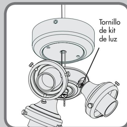
Pase los cables del juego de luz a través del orificio central situado en la caja del interruptor. A continuación fije la caja del interruptor al juego de luz; para ello instale los tornillos del juego de luz en la parte inferior de la caja del interruptor.
