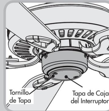
Si la tapa de la caja del interruptor de su ventilador se parece a ésta, quite los tornillos de la tapa con un destornillador estrella (Phillips). A continuación siga las instrucciones de **MONTAJE TIPO A**.
