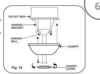
THE FOLLOWING OPERATION MUST BE ACCOMPLISHED BEFORE INSTALLING THE GLASS SHADE.
