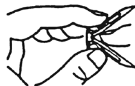
Fig. 17 - Cómo doblar el soporte de expansión
