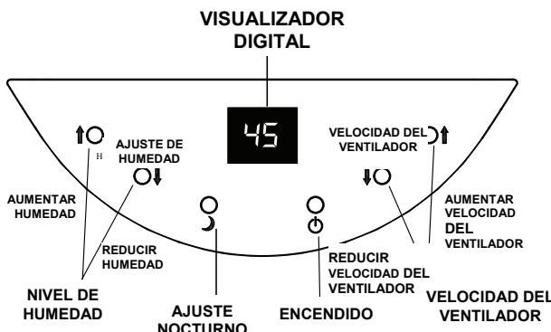
3. El panel de pantalla táctil digital le permite controlar la velocidad del ventilador y el nivel de humedad con solo presionar el botón correspondiente con la flecha hacia arriba o hacia abajo en la parte delantera del panel.
