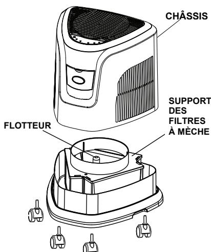
3. Retirez le support des filtres à mèche et le flotteur de la base.
