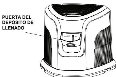
Su humidificador está equipado con una puerta de llenado frontal. Utilice una jarra para llenar la unidad por la puerta del conducto. Cuando la puerta se abre, se enciende la luz LED de la línea de LLENADO MÁXIMO. Llene la unidad hasta que el pequeño flotador blanco alcanza el MAX FILL línea. El depósito tiene 3,5 galones. **No llenar demasiado.**
