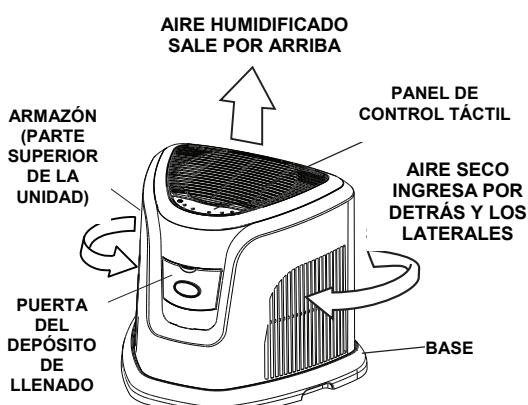
El aire seco ingresa en la unidad por los laterales y la parte trasera, donde el aire circula a través de las mechas saturadas y se humedece antes de que el ventilador lo impulse por la parte superior de la unidad hacia la habitación.
