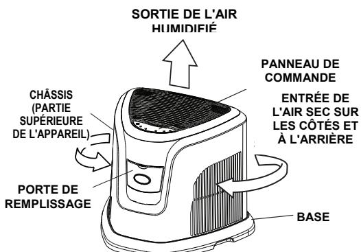
L'air sec est aspiré à l'intérieur de l'appareil par les côtés et l'arrière. Il est humidifié au fur et à mesure qu'il passe à travers les filtres à mèche saturés pour être ensuite poussé par le ventilateur à l'extérieur de l'appareil dans la pièce.
