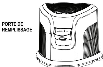
Votre humidificateur est équipé d'une porte de remplissage pratique. Utilisez une carafe pour remplir l'appareil par la porte de remplissage. Lorsque la porte est ouverte, un indicateur LED éclaire le repère MAX FILL (remplissage maximum). Remplir l'appareil jusqu'à ce que le petit flotteur blanc atteint la Ligne de remplissage MAX. Le réservoir peut contenir 3,5 gallons (13 litres). **Ne remplissez pas trop.**
