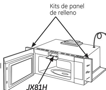
Sólo para instalarse entre armarios, no pueden instalarse al final de los armarios. Cada kit contiene dos paneles de relleno de 3".
