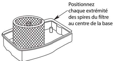
6. Remettez l'ensemble de bâti sur le dessus de la base. Placez à nouveau l'humidificateur dans sa position de fonctionnement.
