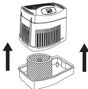
5. Installez un filtre neuf (MAF2) dans la base. Comprimez le filtre et positionnez-le entre les montants au fond de la base. Les deux extrémités des spires du filtre doivent être capturées au centre de la base (cf. diagramme) et le filtre doit reposer sur le fond de la base.
