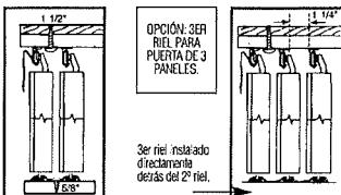
**2** Instalar primero la puerta de atrás. Inclinar la parte inferior de la puerta desde el interior del closet hacia fuera para introducir los rodillos (o guías) en el riel superior. Encajar los rodillos (o guías) en el riel inferior. Instalar la puerta delantera.
