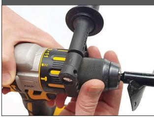
Vérifiez régulièrement l'étanchéité lorsque vous creusez pour éviter de dénuder la tête. Les mandrins en métal peuvent être verrouillés d'un clic en arrière une fois serrés à fond.
