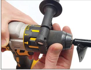
Revise la tensión regularmente cuando cava para evitar estropear la cabeza. Con los portabrocas metales, se pueden cerrar con un clic hacia atrás después de apretarlos completamente.
