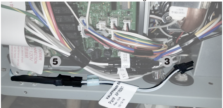
Figure 2. - Créez une boucle sur le côté gauche du chauffe-eau à gaz sans réservoir en passant par l'arrière de l'arrivée et de la sortie d'eau, et en finissant avec la pointe du détecteur sur le bas du côté droit du chauffe-eau. C'est illustré en Figure 3.
