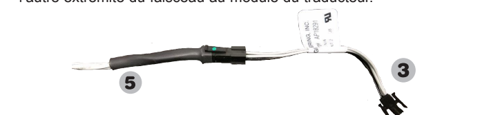
Figure 1 - Références 5 et 3 connectées - Emplacement suggéré pour le détecteur : Faites passer le cordon du détecteur d'eau depuis le côté gauche du chauffe-eau vers son arrière en passant par l'arrière de la carte de contrôle. C'est illustré en Figure 2.
