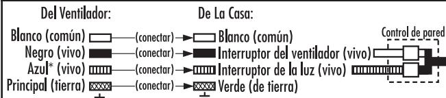
\*Conecte el cable azul sólo si conecta un juego de luces al ventilador.
