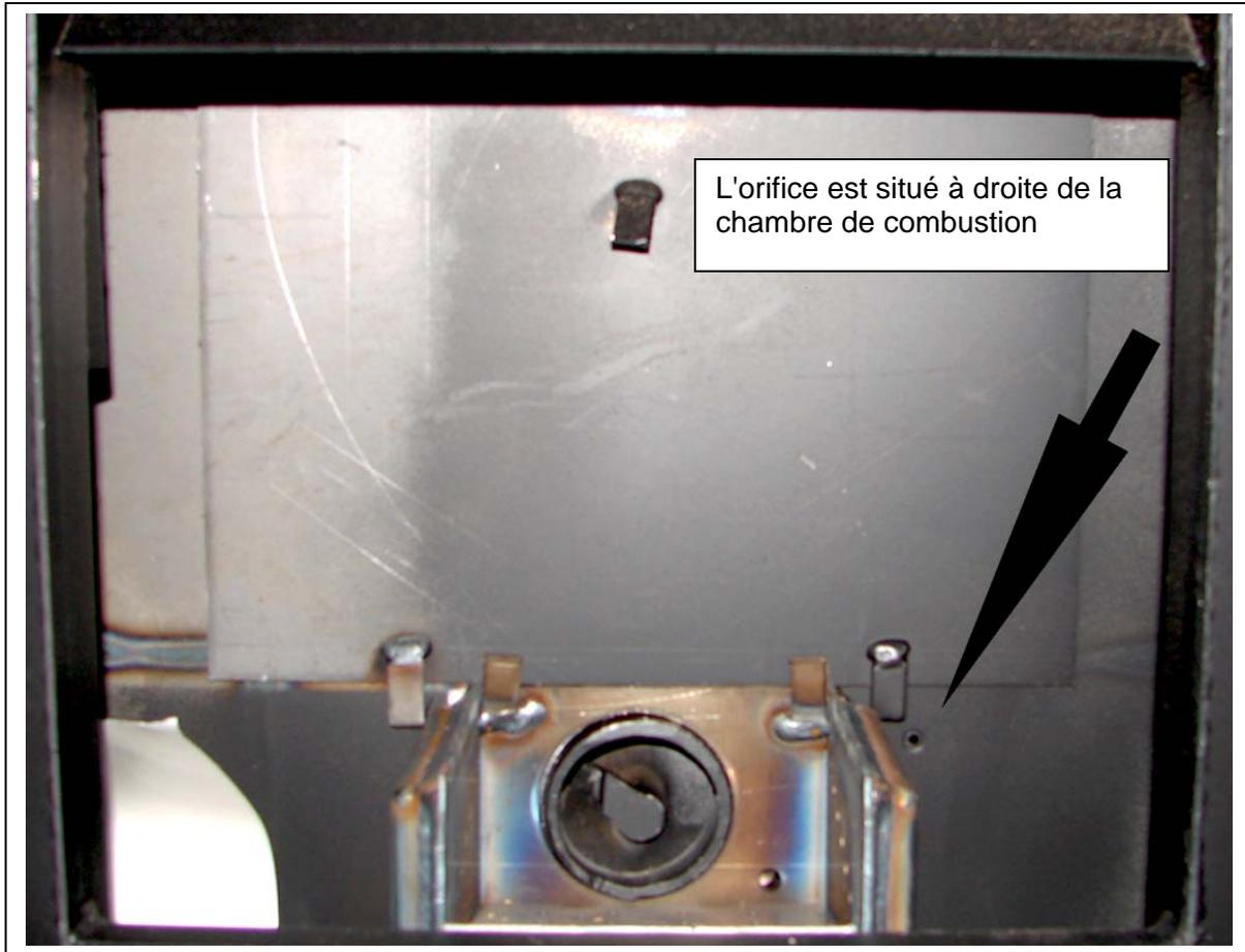
NOTE : Il faut garder propre l'orifice de l'interrupteur sous vide de « porte entrouverte », ou la vis sans fin supérieure cessera de fonctionner. Repérez l'orifice à la droite de la chambre de combustion et le poêle étant débranché et refroidi, utilisez une brosse ou un goupillon (pas un aspirateur) pour garder cet orifice exempt de cendres ou autres débris (voir l'illustration).
