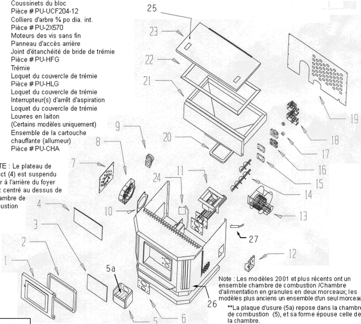
Note : Les modèles 2001 et plus récents ont un ensemble chambre de combustion /Chambre d'alimentation en granules en deux morceaux; les modèles plus anciens un ensemble d'un seul morceau.
